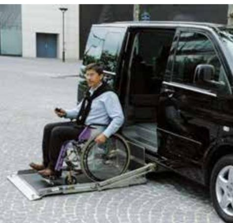
**Plate-forme sous plancher**
