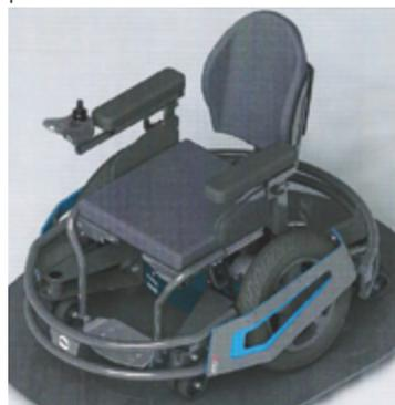
Batterie lithium-ion 32Ah/24V, vitesse maxi 18 km/h, largeur totale 80 cm, hauteur d'assise 38 à 42 cm, roues motrices 16".
