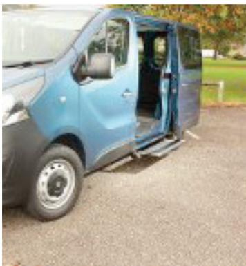
avec l'ouverture de la porte latérale. Après fermeture de la porte, Step-Up reprend automatiquement sa position verticale initiale. D'installation rapide, il permet d'entrer dans le véhicule en toute sécurité grâce au revêtement anti-dérapant. Esthétique,
